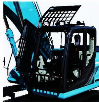
オペレータのアイポイントを基点にした放射状の格子ガードを採用し、クリアな視界を確保します。
