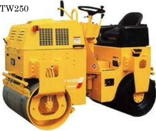
前輪が鉄輪、後輪がタイヤなので1台で振動ローラーとタイヤローラーの2役をこなします。
